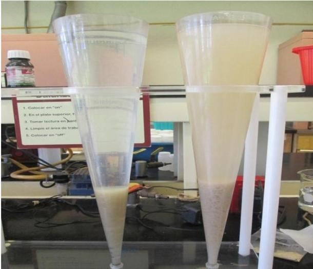
Figura 4. Sedimentación en conos Imhoff. A la izquierda, sulfato de aluminio; y a la derecha, coagulante orgánico. Fuente: Elaboración propia.
