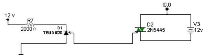
Figura 7. Led infrarrojo y fototransistor. Fuente: elaboración propia.
