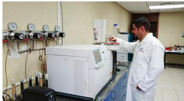
Figura 4. Cromatografía de gases.
