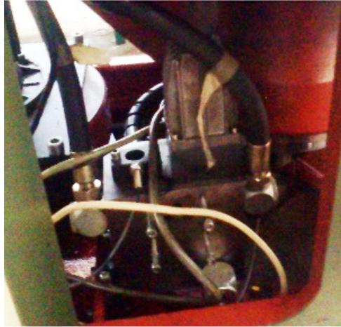
Figura 5. Interior de la máquina Kliken, con el módulo hidráulico instalado.
