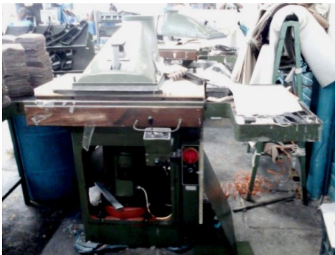
Figura 3. Máquina Kliken parcialmente desarmada (sin el módulo).
