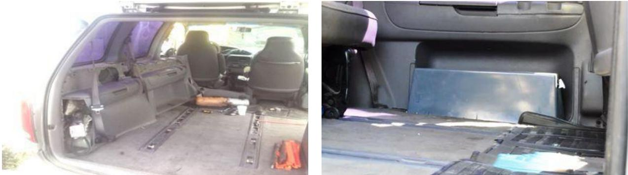
Figura 6. a) Fotos que muestran el espacio para la unidad de potencia, y la unidad ya colocada y puesta la guarda en una camioneta familiar Voyager.
