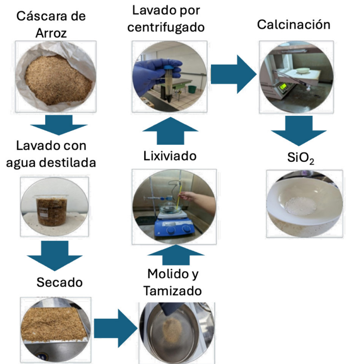
Figura 2. Proceso de síntesis para el SiO 2 a partir de cáscara de arroz (elaboración e imágenes propias)
